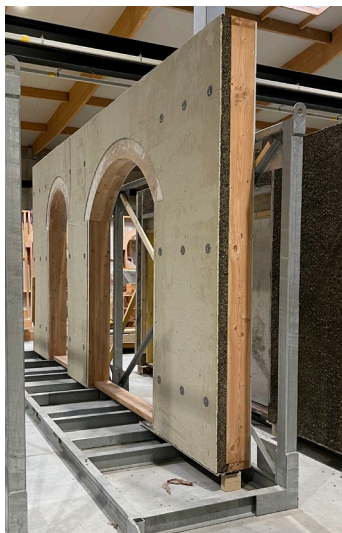
Image 6 : mur Wall'up avec linteaux cintrés
