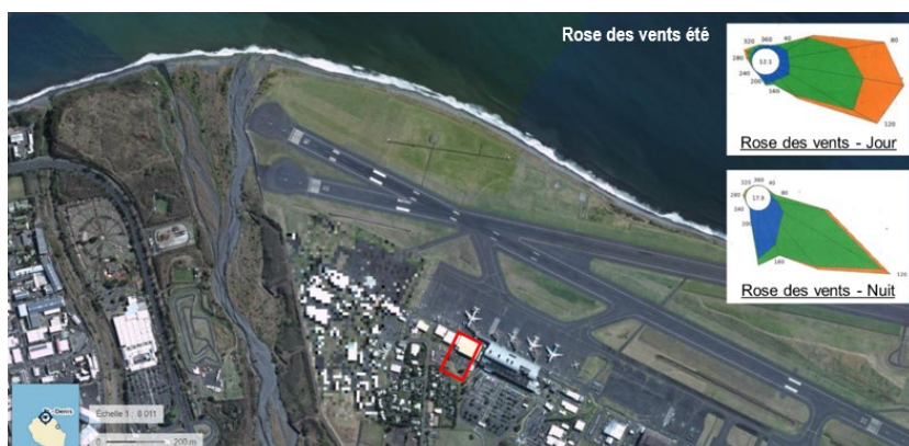
Implantation de l'aéroport et rose des vents
