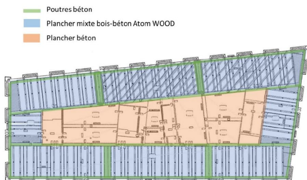
Image 6 : Vue en plan du plancher (du R+1 et du R+3 au R+8 – vue archi en haut, structure en bas) avec identification des zones couvertes par le plancher mixte bois/béton
