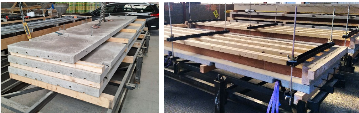
Image 4 : Séchage des dalles béton, puis collage avec les éléments bois
