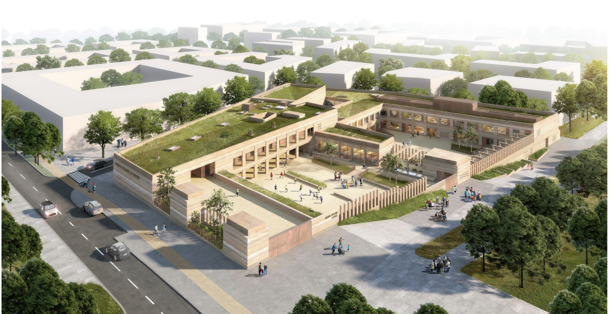
Perspective aérienne – Façades porteuses en béton sec damé
