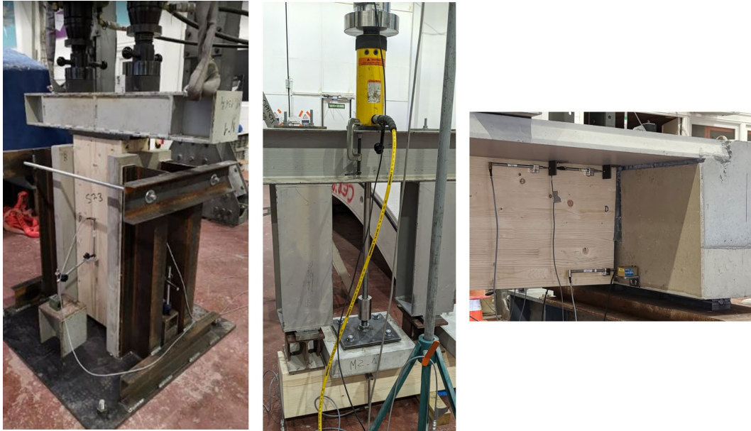
Image 6 : Essais push-out, d'arrachement et de cisaillement d'about
