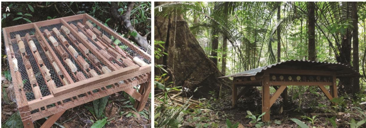
Fig. 2 : Dispositif expérimental couvert et hors sol pour évaluer la durabilité naturelle des essences en conditions d'usage (3 répliques en milieu forestier, 3 répliques en milieu urbain).
