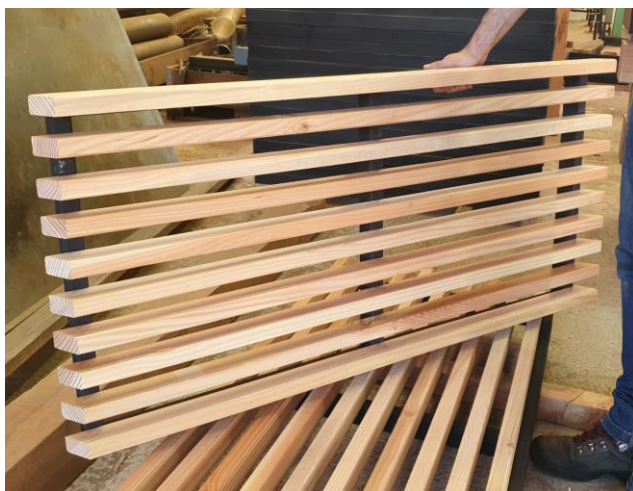
Fixation des tasseaux de finition des Sylvacoustik
