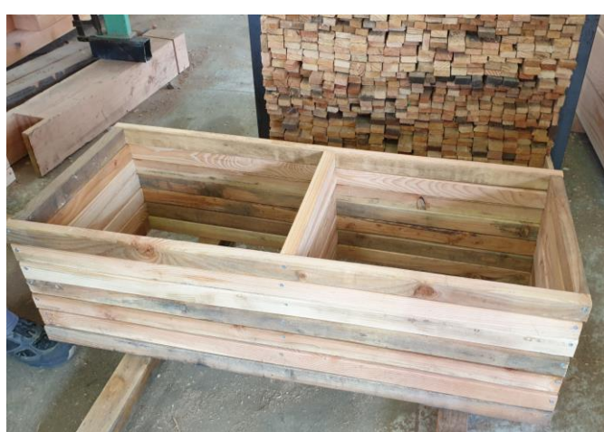
Assemblage des cadres des panneaux Sylvacoustik
