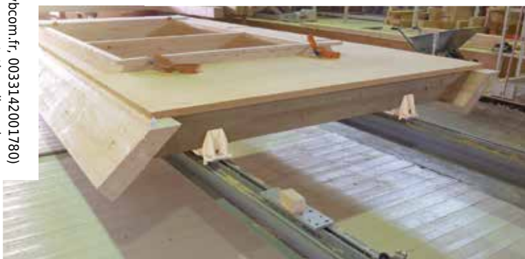
1 / Élément de toiture avec construction montant-traverse intégrée : réalisation aisée de pannes en saillie verticale
